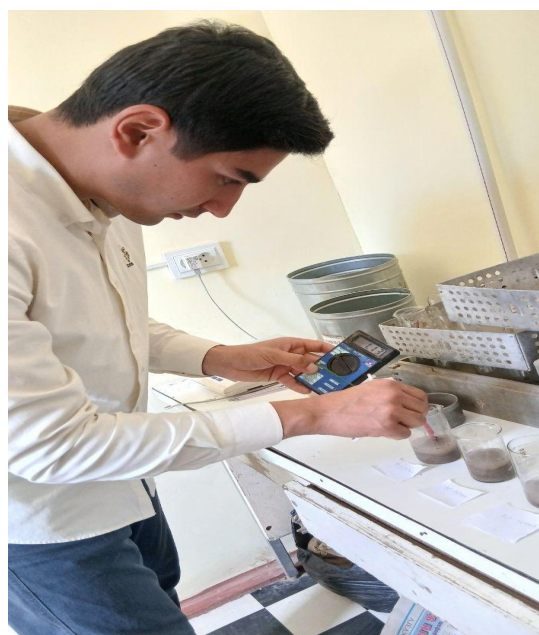
5-rasm. Tuproq sho'rlanish darajasini aniqlash, laboratoriya jarayonlaridan fotolavhalar
