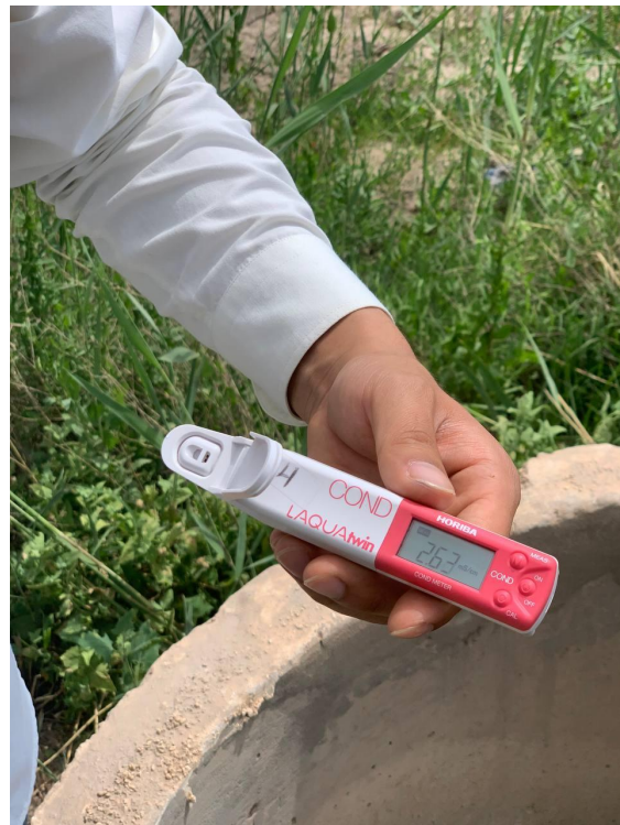
4-rasm. Kuzatuv quduqlarini mineralizatsiyasini aniqlash jarayoni
