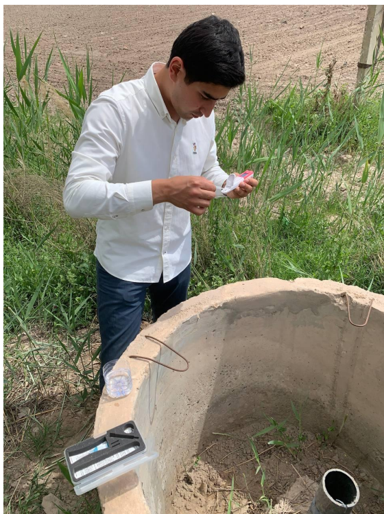
4-rasm. Kuzatuv quduqlarini mineralizatsiyasini aniqlash jarayoni
